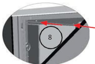
8. Enfin, serrer le module de récupération de chaleur avec les 4 boulons 8 x 60 mm pour compresser la mousse (2 boulons sur les barres de montage supérieures (détail) et les 2 boulons mis en place à l'étape 7).
