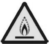
Le logo A2L sur la plaque signalétique indique que le produit contient un fluide frigorigène de catégorie légèrement inflammable. Il est aussi positionné sur les schraders où des composants frigorifiques peuvent être connectés pour la maintenance. Cette étiquette vous indique qu'il y a un risque potentiel de fuite de gaz inflammable et qu'il faut en tenir compte dans l'analyse de risque d'exploitation.
