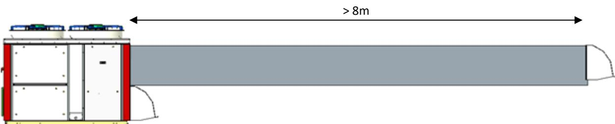
Il est préconisé de gainer le rejet d'air de 8m (selon réglementation locale) par rapport à l'entrée d'air neuf lorsque l'entrée-sortie se trouvent du même côté.
