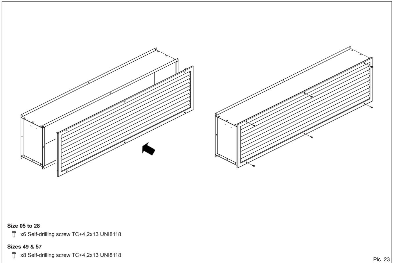
**INTAKE GRILL ON RAM ASSEMBLY DIAGRAM**
