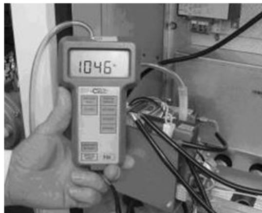
La pressione in uscita deve essere misurata dal rubinetto posto sulla barra di supporto dell'iniettore del gas per evitare la caduta di pressione dovuta al gomito posto dopo la valvola
