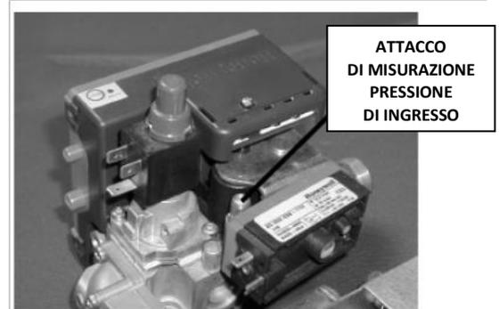
Controllare e, se necessario, regolare la pressione di ingresso della valvola dopo l'accensione del bruciatore.
