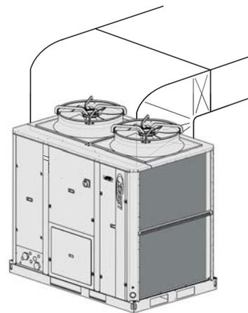
Sur les pompes à chaleur à deux circuits et les unités en froid seul 100D-140D, si une seule gaine doit être installée, un atténuateur de pression régulé doit être installé pour chaque ventilateur afin d'éviter un by-pass d'air au travers du ventilateur si ce dernier a été arrêté.
