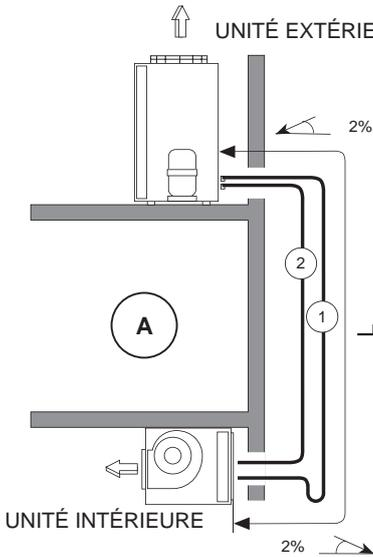
**POSITION A :** un siphon d'aspiration doit être installé sur la partie verticale de la conduite de gaz et des siphons doivent être installés tous les 8 mètres sur la section ascendante. La vitesse d'aspiration minimum ne doit pas être inférieure à 6 m/s. La longueur verticale maximum est de 16 m.
