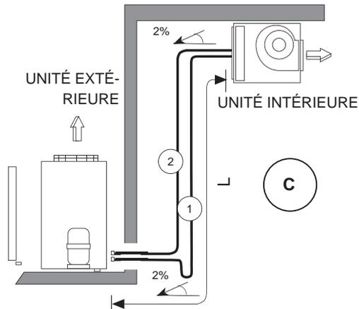
**POSITION C :** Installer un siphon à la base de la partie verticale de la conduite de gaz. Aucun autre siphon n'est nécessaire. La longueur verticale maximum est de 16 m.
