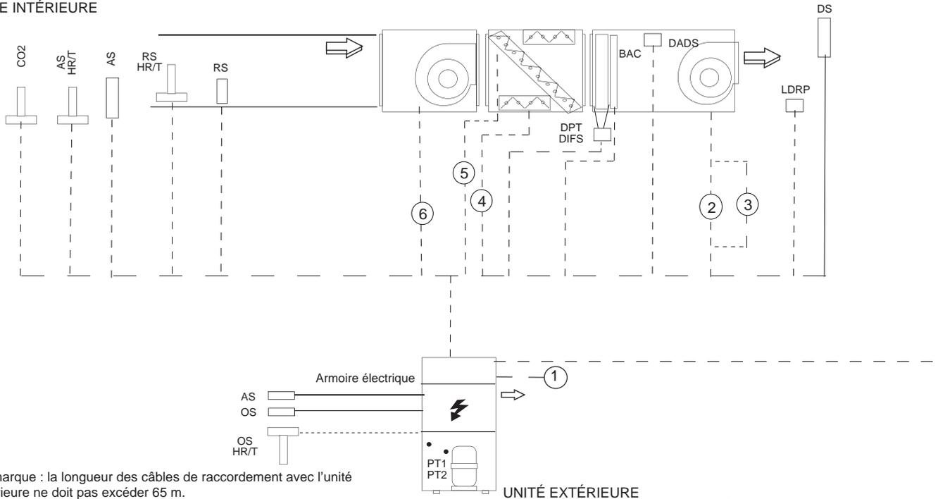
Remarque : la longueur des câbles de raccordement avec l'unité intérieure ne doit pas excéder 65 m.
