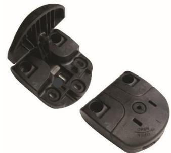
Los cierres también deben ajustarse en posición vertical para facilitar la apertura/cierre de todos los paneles una vez que la unidad está instalada definitivamente en su posición final. Se proporciona una libertad de +/-5 mm a todos los cierres.
