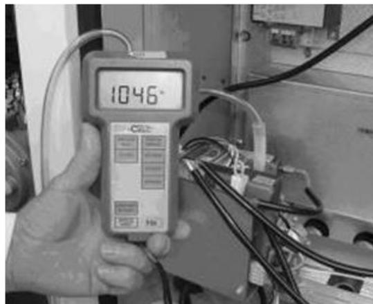
La presión de salida se debe medir en la toma de presión situada en la barra de soporte del inyector de gas para evitar una pérdida de carga debida al codo después de la válvula.
