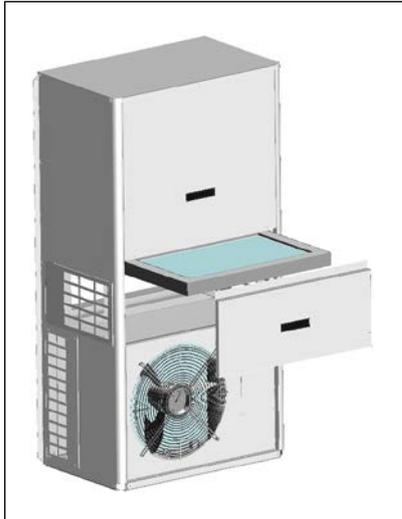
A) En enlevant le panneau placé sur le ventilateur condenseur on accède au logement du volet et du filtre à air.
