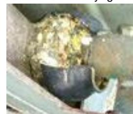
Corrosion galvanique sous la gaine en plastique.
