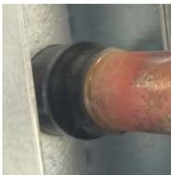
Las uniones de las líneas frigoríficas de cobre con las baterías microchannel de aluminio están protegidas contra corrosión por par galvánico mediante una resina especial encapsulada en una manguito termo retráctil.
