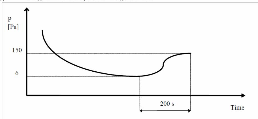
La Fig. 4 montre un cycle de tirage au vide suivi de la remontée de la pression jusqu'au niveau optimal pour les appareils frigorifiques tels que ceux objet du présent manuel. D'une manière générale, quand est
