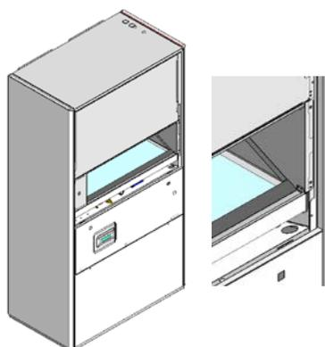
3. Retirer le volet complet et accéder au servomoteur
